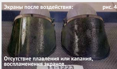
Отсутствие плавления или капания, воспламенения экранов.
